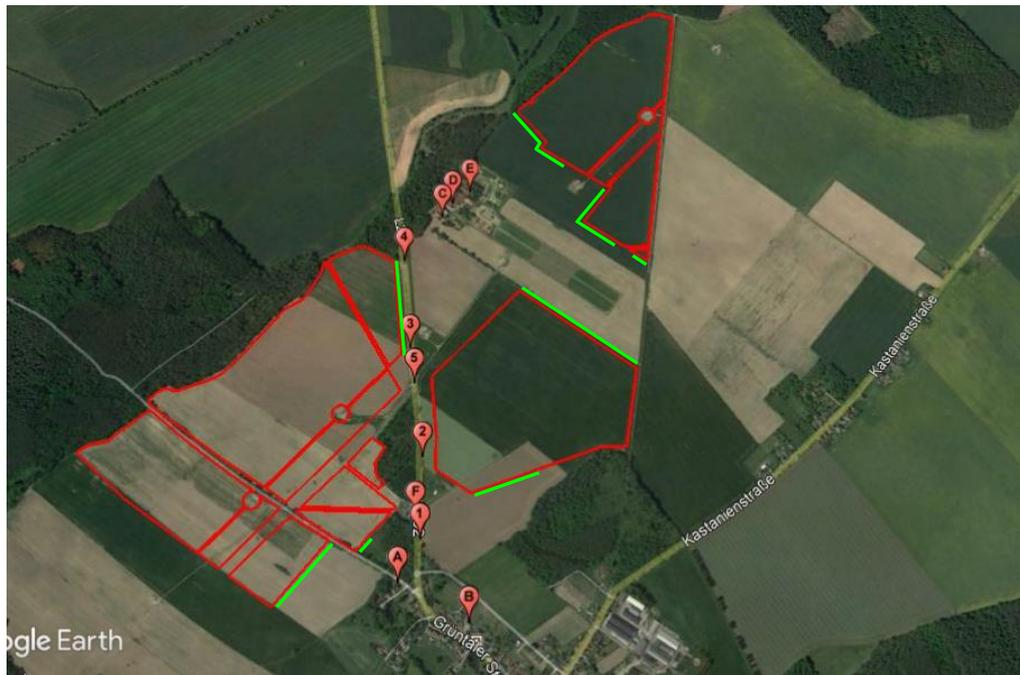
*Bild 1: Die 14 Teilflächen der geplanten PV-Anlage Tempelfelde mit den Blickpunkten/Immissionsorten A bis F und den Blickpunkten 1 bis 5 auf der L 292
